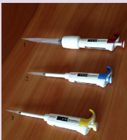
Рис. 5. Пипетки дозаторы одноканальные переменного объёма: 1 — 110 мл; 2 — 100—1000 мкл; 3 — 10—100 мкл.
