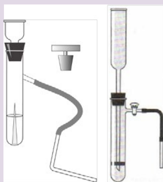
Рис. 7. Прибор для получения и собирания газов
